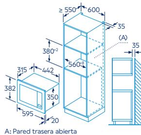
Montaje de un microondas de 20 l en un mueble alto
